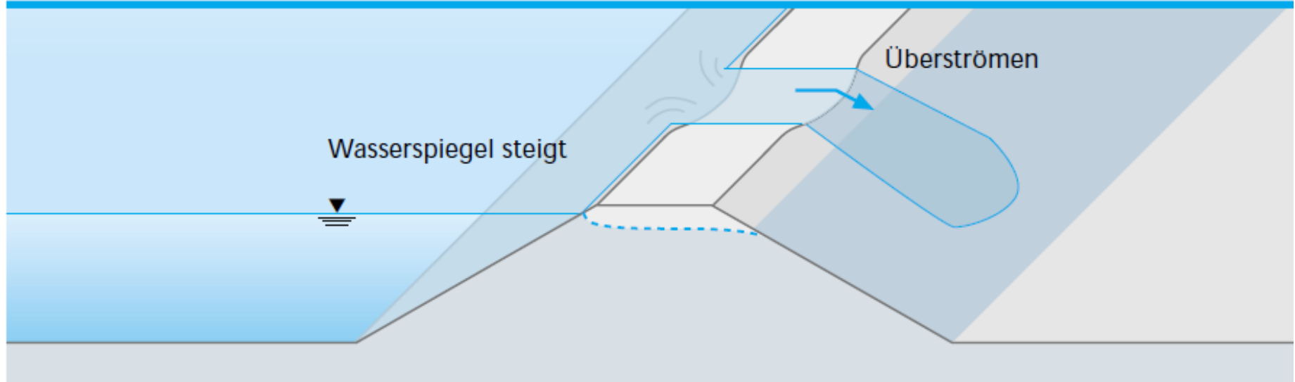
Abb. 22 Gefahr des Überströmens
