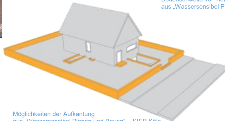
Bodenschwelle vor Tiefgaragenzufahrt aus „Wassersensibel Planen und Bauen“ – StEB Köln
